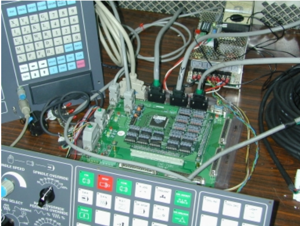
圖四：遠端輸出入模組的應用---車銑床控制器(由數控部提供)
